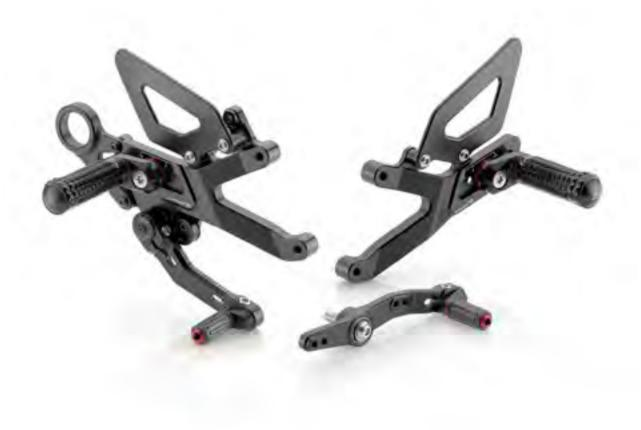
MACHINED FROM BILLET ALUMINUM | ADJUSTABLE TO 18 POSITIONS | ECCENTRIC SYSTEM MOUNTED ON THE LONGITUDINAL CARRIAGE AVAILABLE REVERSIBLE SHIFT
