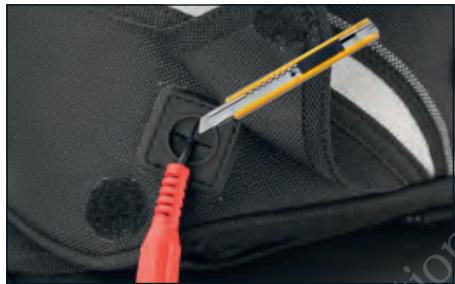
Elektro-Zugang mit Messer auftrennen / Disconnect electrical access with a knife
