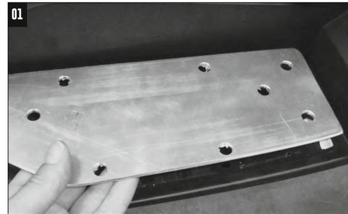
Die Gummimatten der Trittbretter entfernen, diese sind nur geklipst. Die Adapterplatten in die Vertiefung der Trittbretter einlegen. Verbindungsschraube unter dem Hauptscheinwerfer entfernen, diese entfällt.
