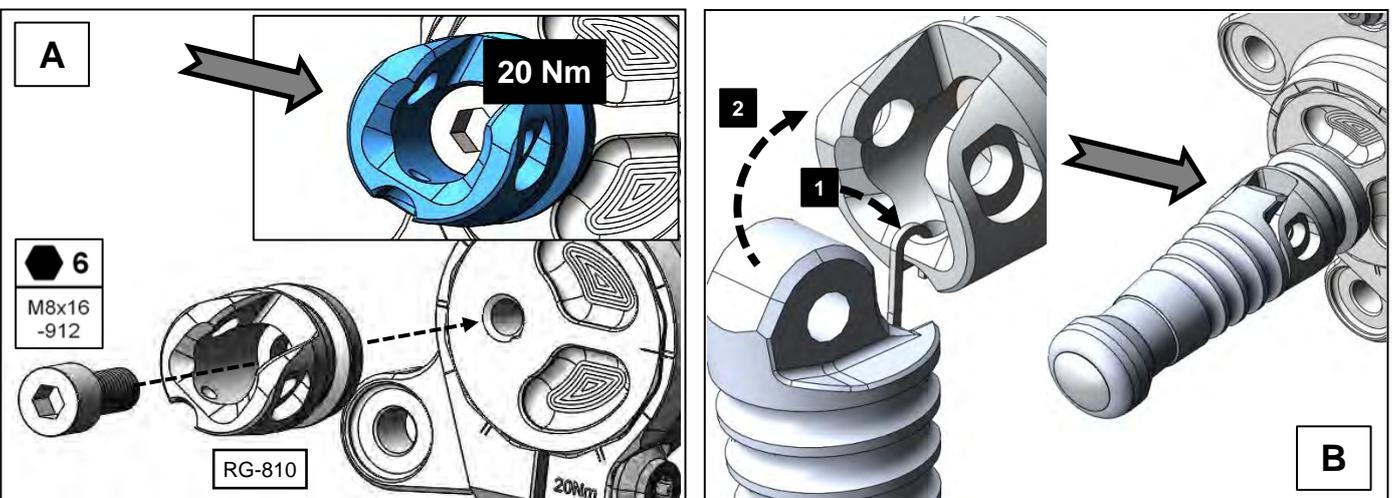
**A:** Gelenk RG-810 gemäß Angaben aus Einstellvorgabe 1 auf die Rastenanlage montieren. **Anzugsmoment: 20 Nm!**
