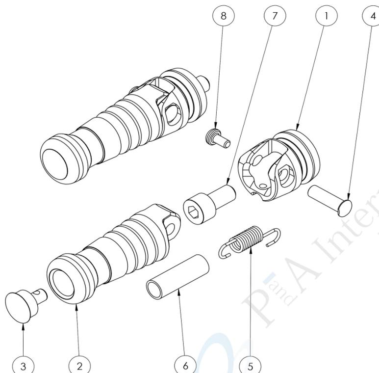
**1 Einstellvorgabe:** Fußraste darf nur nach oben und leicht nach hinten klappen. Raste muss stets auf die Verstellungen der Fussrastenanlage angepasst werden!
