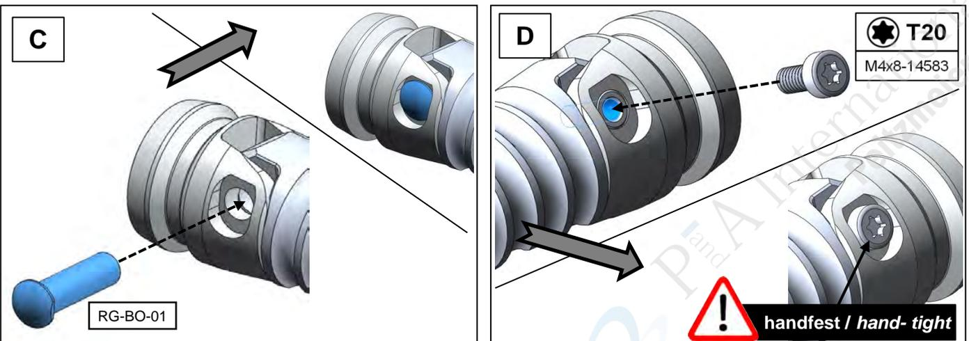
**C+D:** Setzen Sie den Bolzen (RG-BO-01) ein und verschrauben Sie diesen **handfest** (Schraube M4x8-14583)!
