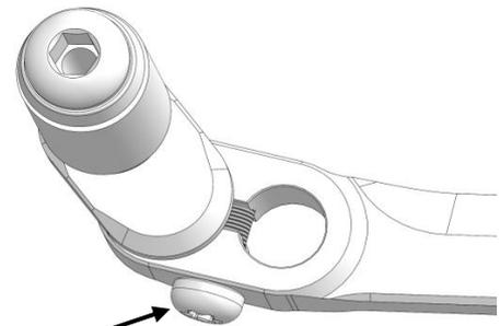
Trittstück umsetzen / move the toe piece
