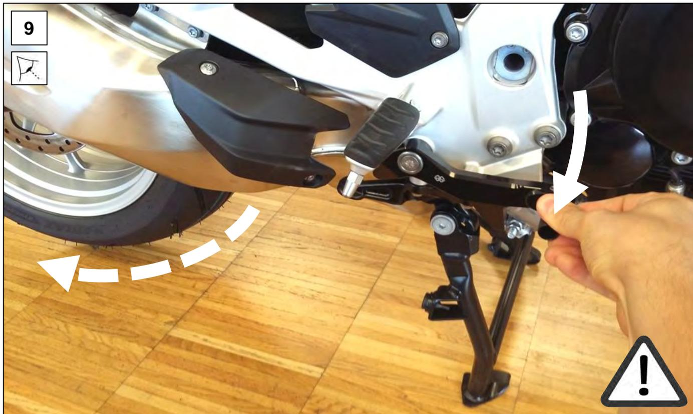
**Zur Durchführung des folgenden Tests sollte das Hinterrad frei drehbar in der Luft sein!**
