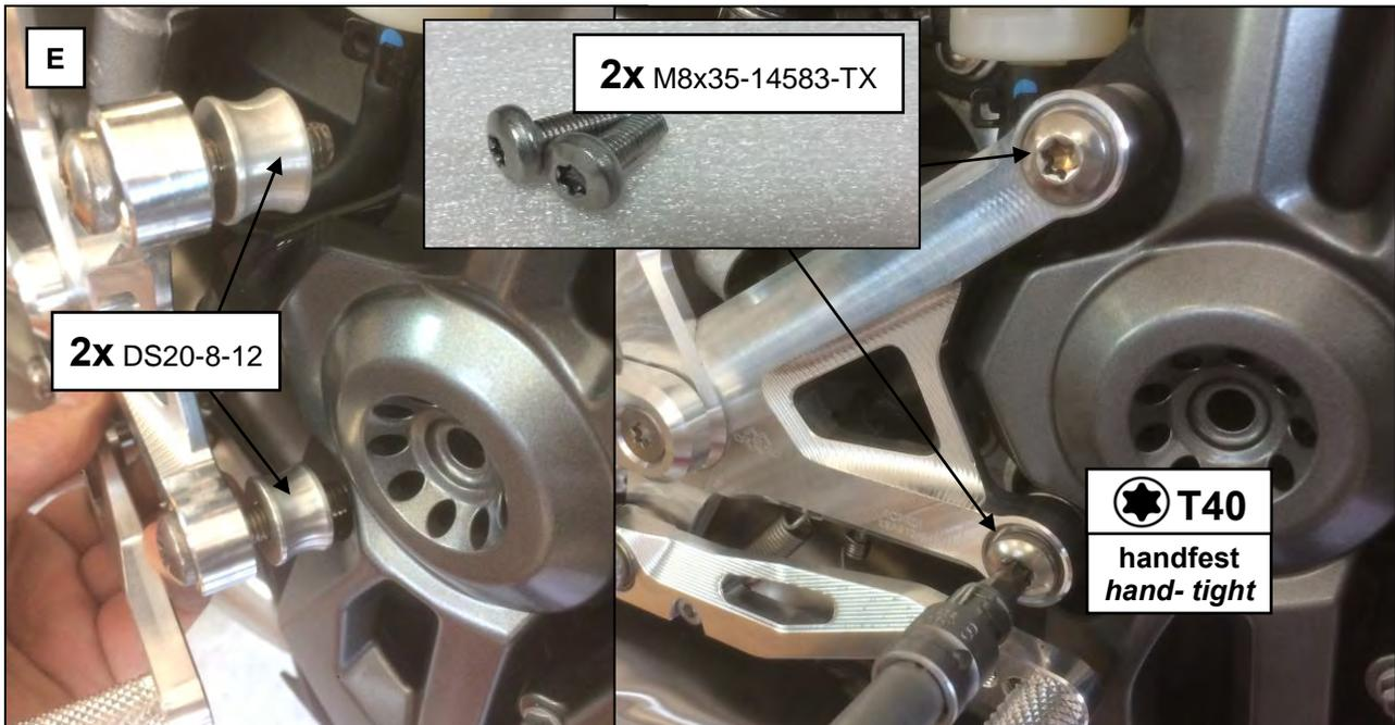
**E:** Montieren Sie die Rastenanlage an den Rahmen und schrauben Sie diese mit den beiden Schrauben **M8x35-14583-TX** und den Distanzscheiben **DS20-8-12** handfest an.
