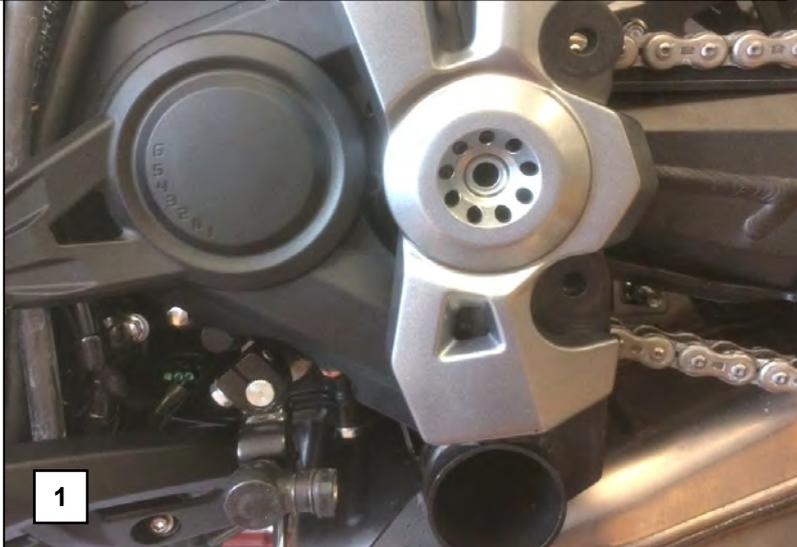
1: Originale Rastenanlage demontieren und angrenzende Fahrzeugteile gegen Beschädigungen schützen.
