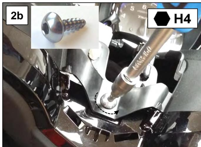
**2a:** Entfernen Sie die dargestellte Lenkerverkleidung indem Sie die markierte Originalschraube entfernen.
