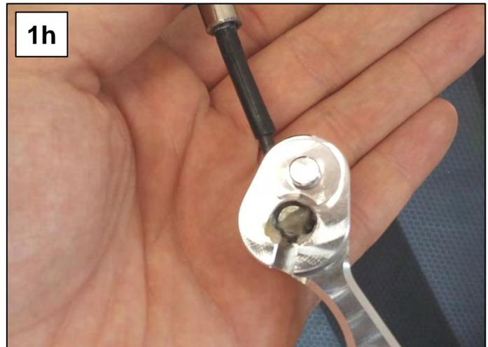
**1g:** Hängen Sie den Bowdenzug aus den entsprechenden Bauteilen aus und schmieren Sie dessen Endbolzen mit handelsüblichem Industriefett.
