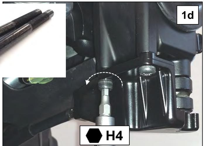
**1c/1d:** Demontieren Sie wie dargestellt die beiden originalen Zylinderkopfschrauben.
