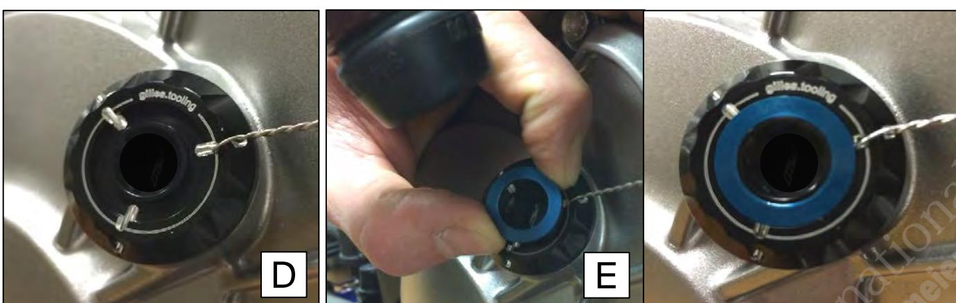
**D: (Optional)** Setzen sie bei Bedarf einen Sicherungsdraht durch die Bohrung und befestigen diesen an einer geeigneten Schraubenverbindung des Gehäusedeckels.
