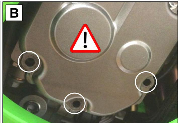
**A:** Entfernen Sie die 3 originalen Schrauben des Gehäusedeckels.
