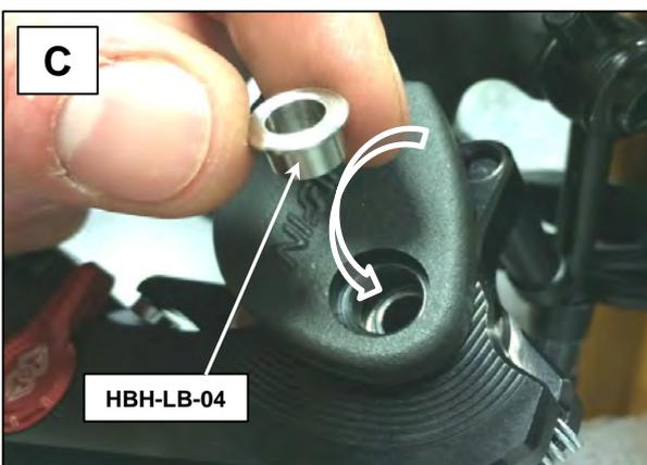
**C:** Setzen Sie die Lagerbuchse **HBH-LB-04** in die obere Gabelbohrung der Bremspumpe.
