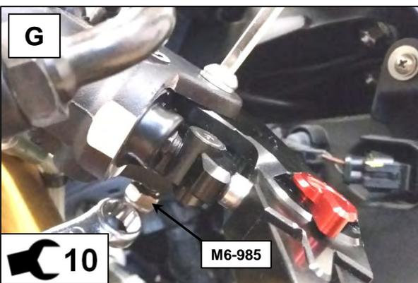
**G:** Kontern Sie die Montage des Hebels durch gegenschauben der Sicherheitsmutter **M6-985**. **Handfest!**
