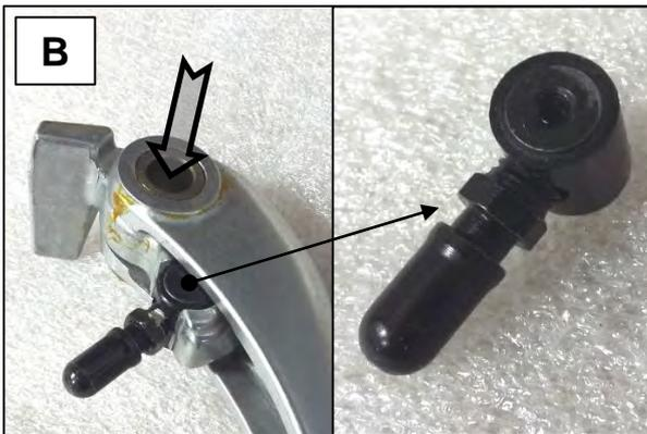
**B:** Zerlegen Sie den originalen Hebel um an den Druckbolzen zu gelagen!
