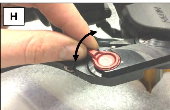
**H:** Griffweite einstellen. Wählen Sie eine, für sich individuell geeignete Griffweite. Die Hebelverstellung erfolgt durch das Drehen am zentralen Stellrad.
