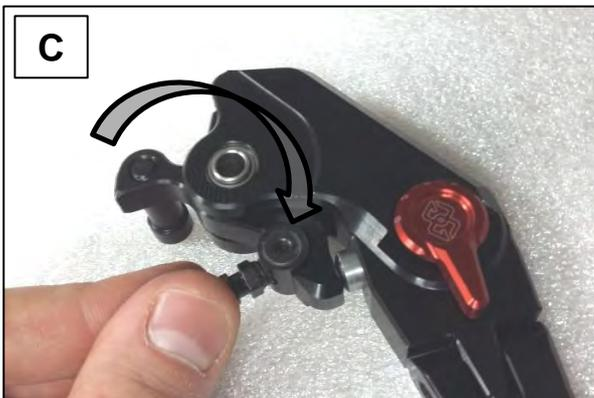
**C:** Stecken Sie den OE- Druckbolzen gemäß Darstellung in die Kreistasche des Bremshebels.
