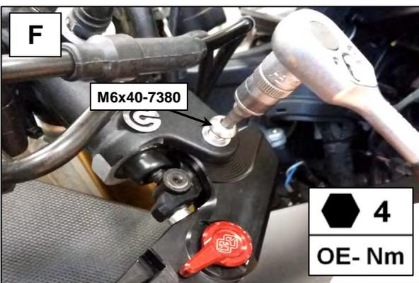
**F:** Fixieren Sie den Hebel! Verwenden Sie die mitgelieferte Schraube **M6x40-7380**.
