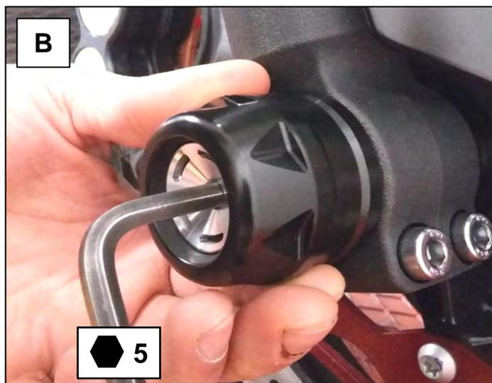
**A:** Schieben Sie die vormontierte, rechte Seite mit deren Gewindestange durch den Crashpad **GTA-CP-11**. Diese Verbindung bis zum Anschlag mit dem Gabelfuß in die Hohlachse einsetzen (siehe auch Bild B).
