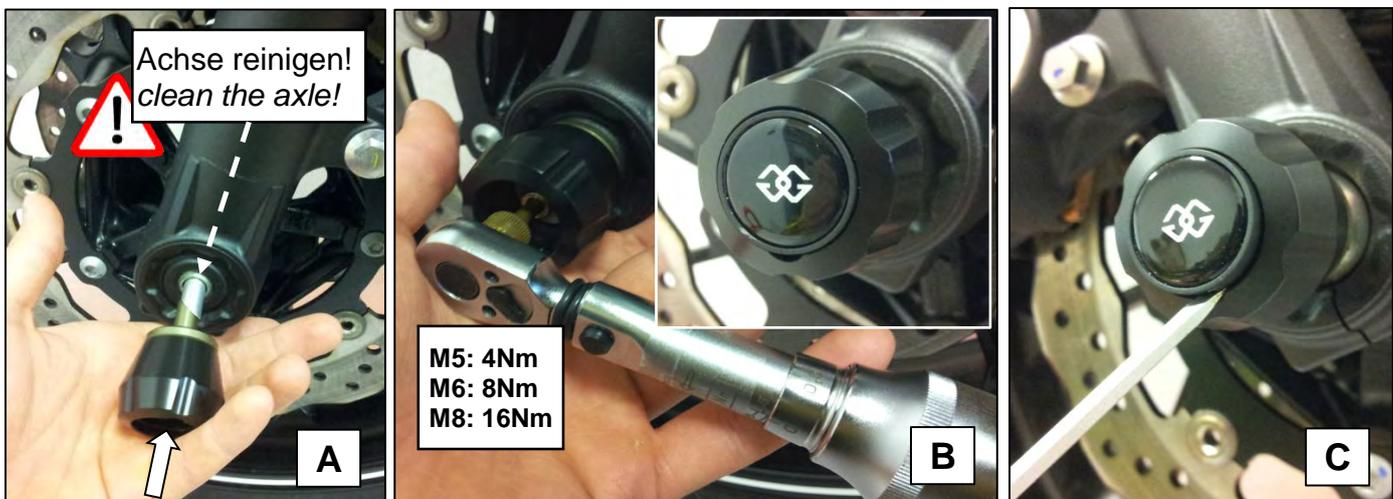
**A:** Der Ablauf wird exemplarisch für die GTA- Produktgruppe gezeigt. Es handelt sich um beispielhafte Abbildungen. Der Montageablauf ist auf beiden Seiten prinzipiell identisch und es besteht auch kein unterschied zwischen Vorder- und Hinterachse! Prüfen Sie durch Messen welcher Außendurchmesser zu der entsprechenden Motorradseite passt. Stecken Sie nun den Protektor mit dem Klemmelement in die gesäuberte, fettfreie Hohlachse!
