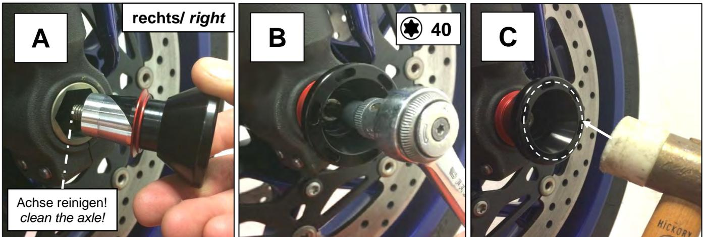
**A:** Schieben Sie die Blende **GTA-BL-01** wie dargestellt auf den Achsprotector und setzen diesen anschließend in die gereinigte und fettfreie Hohlachse ein. **(Die flache Seite der Blende muss Richtung Achse zeigen)**
