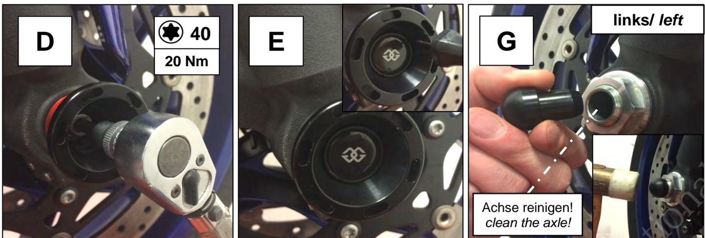
**D:** Anziehen der Schrauben mit Drehmomentschlüssel. **Anzugsdrehmoment: 20 Nm**
