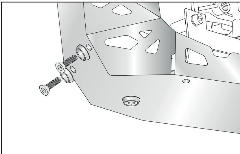
**Montage der Motorschutzplatte rechts/links:**
