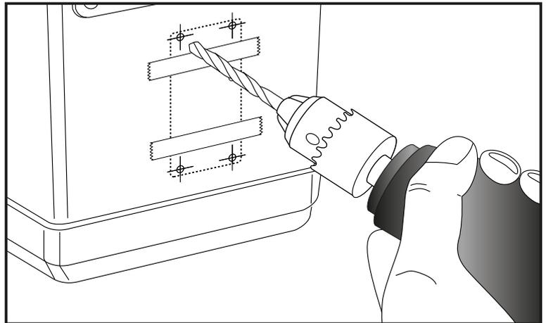
**\*Nicht für die Montage am Xceed Seitenkoffer gültig ! Hierfür die Schablone aus dem Zusatzkit 740037 verwenden.
