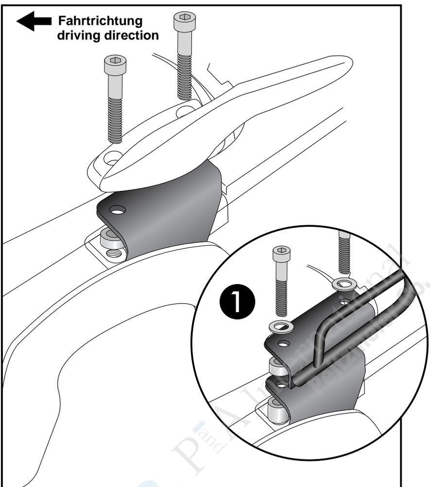
Bei zusätzlicher Montage einer Gepäckbrücke werden die Alu-Distanzen  $\varnothing 18 \times \varnothing 9 \times 15$  mm zwischen Brücke und C-Bow positioniert und mit den Zylinderschrauben M8x70 sowie U-Scheiben  $\varnothing 8,4$  mm verschraubt!
