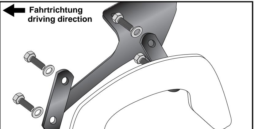
Die so vorbereiteten C-Bow incl. Halteadapter über den Verschraubungspunkten der Haltegriffe positionieren und zusammen mit den Haltegriffen wieder am Rahmenheck verschrauben. Hierzu die Zylinderschrauben M8x70 verwenden. Als Abstandshalter jeweils eine Aludistanz  $\varnothing 18 \times \varnothing 11 \times 26$  mm einfügen.
