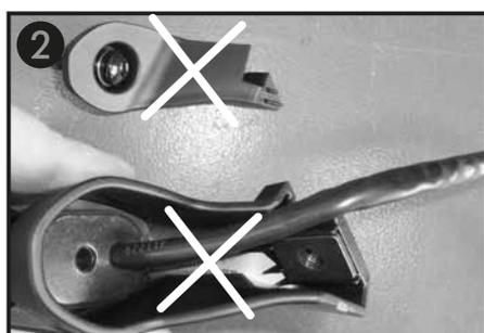
Die Soziusfußrastenhalter rechts und links entfernen, Originalschrauben entfallen. Die beiden Schrauben hinten unter dem Heck entfernen, diese entfallen.
