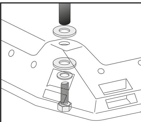
Die Reling wird auf dem Deckel montiert.
