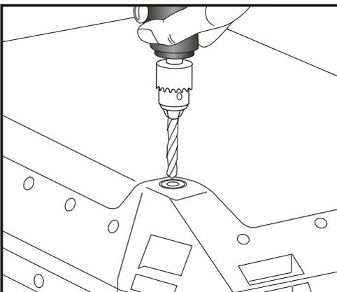
Die Reling wird auf den Kunststoffecken des Deckels montiert. Dazu müssen die Niete mit einem Bohrer  $\varnothing 6,5\text{mm}$  aufgebohrt werden.
