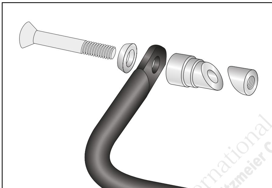
Die rechte Seite vormontieren: die abgesetzte Aludistanz mit der Gewindedistanz am rechten Bügelende mit der Senkschraube M8x60 und Senkscheibe M8 nur locker verschrauben. Die vorbereitete Seite in das rechte Lenkerende fügen und ausrichten. Links die Gewindedistanz, dann die abgesetzte Aludistanz in das Lenkerende fügen.
