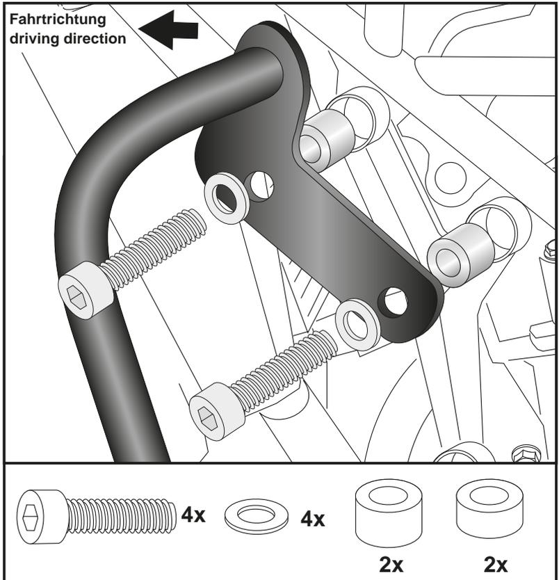
Montage des Motorschutzbügels vorne:
