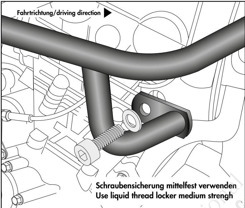
Die Schraube der vorderen Motoraufhängung links entfernen. Schraube wird wieder verwendet.
